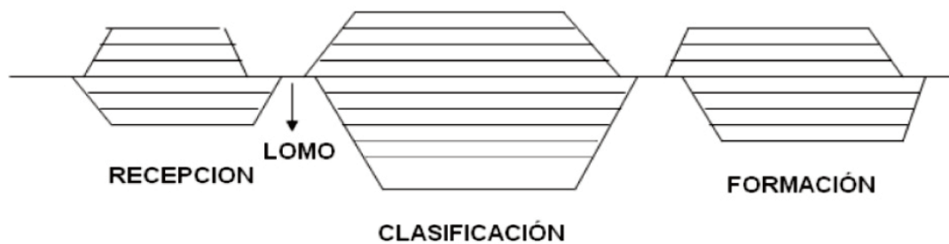
Figura 1. Esquema de estación de clasificación de mercancías.
